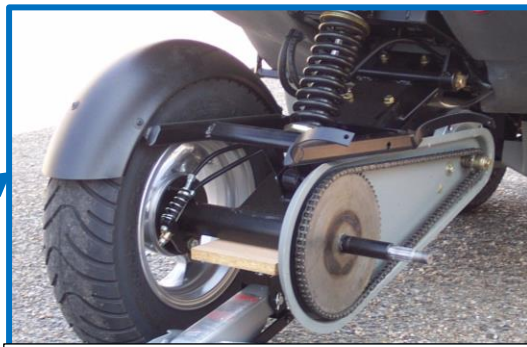
Photo essieu arrière du Scootcar. (Roue arrière droite enlevée)
