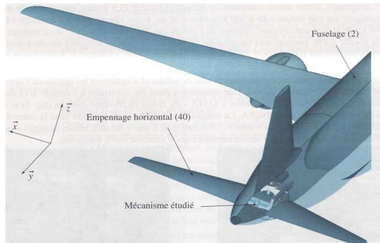
L'énergie mécanique est fournie par un moteur électrique **12** de type pas à pas, lié rigidement au boîtier basculant **(4,5)** par l'intermédiaire du support moteur **17**. Le boîtier basculant **(4,5)** est en liaison pivot par rapport à l'armature **1** fixée au fuselage **2** de la maquette. Cette énergie est transmise à la vis du système vis-écrou à rouleaux **(6-9)** par l'engrenage à denture droite **(18-23)**.
