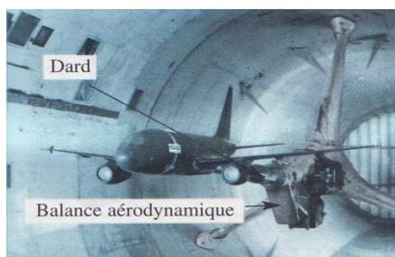
La maquette est maintenue en position dans la veine d'étude de la soufflerie à l'aide d'un « dard », lui-même relié à une « balance aérodynamique » qui mesure l'intensité des différentes actions aérodynamiques qui s'exercent sur la maquette.
